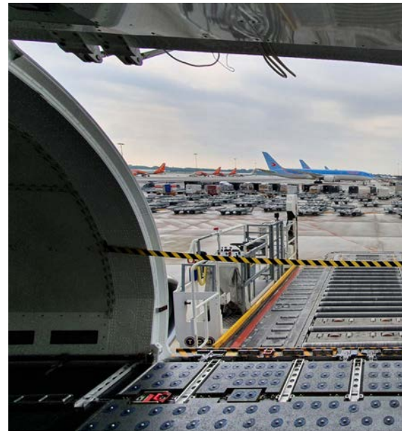
Die nachträglich eingebaute Frachttür misst 3,00 mal 2,10 Meter
