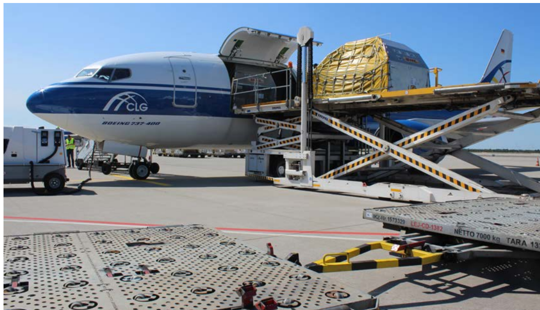
Elf Standardpaletten oder -container verschwinden innerhalb kürzester Zeit im Rumpf der Boeing 737-400SF
