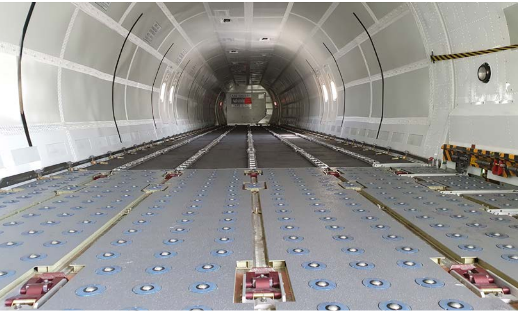
Rollen im Fußboden erleichtern das Beladen der Frachter mit Containern und Paletten extrem
