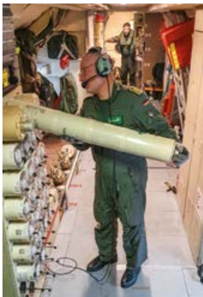
Die Bojen werden durch den sogenannten Bojenslot und die Schächte im Rumpfboden der Orion ausgestossen.
