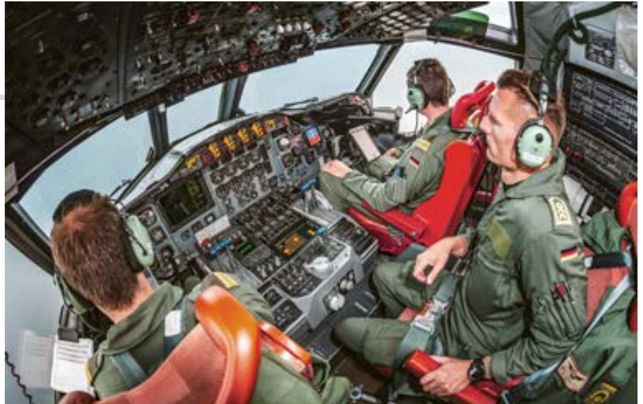
Das Cockpit der P-3C Orion mit analogen und digitalen Instrumenten. Üblicherweise besteht eine Cockpitcrew aus Pilot, Copilot und Bordmechaniker. Foto Bundeswehr
