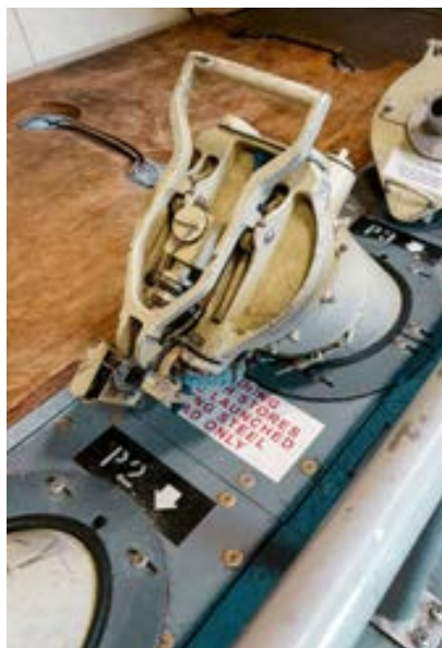
Die Bojen werden durch den sogenannten Bojenslot und die Schächte im Rumpfboden der Orion ausgestossen.
